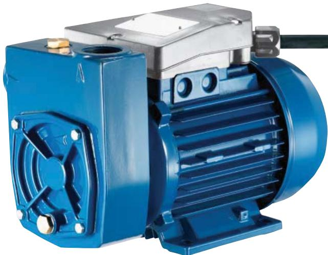
Pompa volumetrica ad anello liquido con girantestellare che conferisce alla pompa una notevole capacità aspirante. Particolarmemente adatte nelle operazioni di travaso di liquidi (anche volatili). Corpo pompa con chiusura in ottone a riduzione del rischio di bloccaggio.
