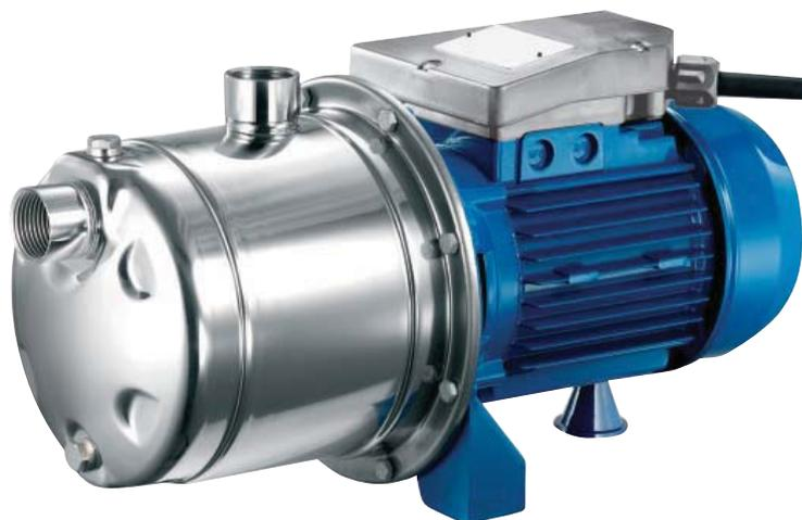
Pompe centrifughe multistadio, orizzontali e auto-adesanti, particolarmente adatte alla realizzazione di piccoli e medi gruppi di pressurizzazione; in grado di aspirare liquidi miscelati ad aria o a gas.
