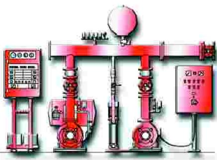
Equipos totalmente automáticos para el servicio contra incendios construidos bajo normativas actualmente demandadas como UNE, CEPREVEN, NFPA, etc. Formado por bombas principales eléctricas o diesel y bomba auxiliar jockey.
